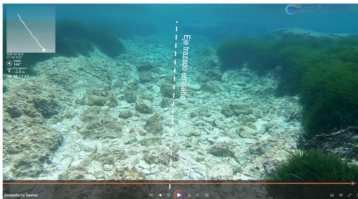
Imagen 20 Prof = 2.0 m. Inexistencia de biocenosis en el ámbito de la zanja que alberga el actual emisario. Alta densidad de matas de posidonia oceanica. Sí se identifican los laterales de la zanja . Se observa el fondo rocoso den entorno
